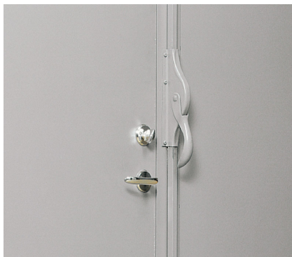
Parhalvan är försedd med anslag och som standard med spanjolett på anslagssidan. Kantregel i rostfritt material som standard för rostfria dörrar.
